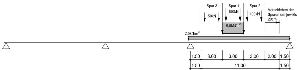
Abbildung B-7 Laststellungen für das minimale Moment im Randfeld und über Stütze B
