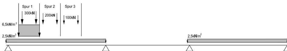
Abbildung B-3 Laststellung maximale Beanspruchung Bogen A
